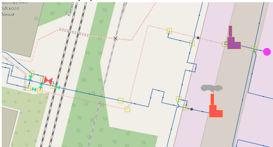
Рисунок 7– – Аварийное отключение Котла №2 и коллектора Ду800
